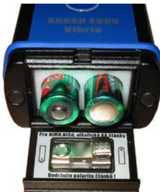
Obr. Umístění napájecích baterií
